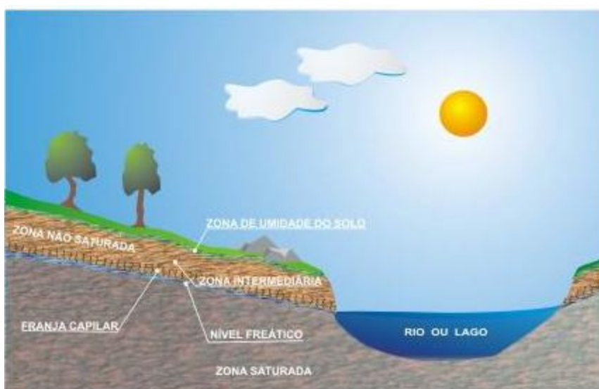
Figura 3 – Caracterização esquemática da zona não saturada e saturada no subsolo (Borghetti et al., 2004).
